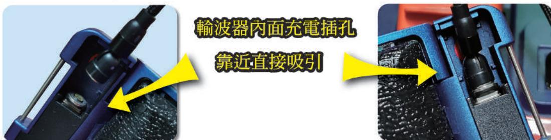
(3) 按下主機右下角的電源按鈕。看到輸波器偵測到藍燈恆亮(固定亮著)，電流表有運作，表示確定有插好，可以充電了，即可離開。
